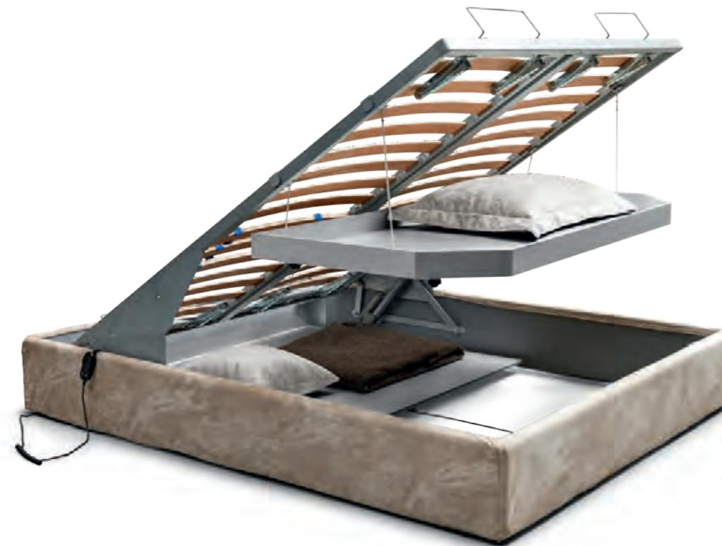
Sistema alzaletto GOLD solo motorizzato, completo di due attivatori elettrici, software di controllo e decoder per la misurazione del sincronismo del movimento, centralina, comando pulsantiera e cavo trasformatore. Test eseguiti per 20.000 cicli di apertura e chiusura.
