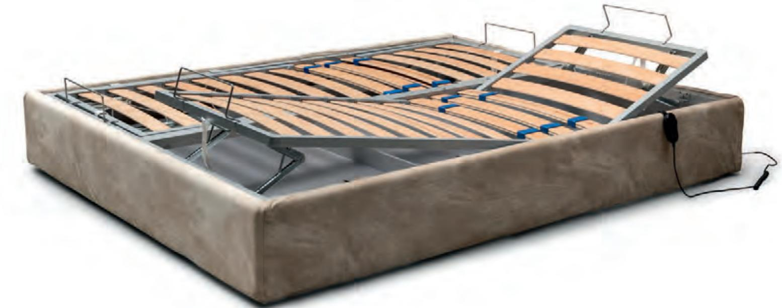
DISPONIBILE MANUALE O MOTORIZZATA. Anatomica, struttura metallica, profilo da 40 x 30 con angoli a 90° verniciata a polveri colore grigio, 14 + 14 listelli in faggio evaporato da 68 mm. x 8, posizione lombare con doppie doghe (3 + 3) e regolatori di rigidità del peso. NB – i dati sono riferiti alla rete da 160 x 200.
